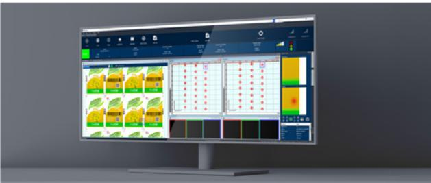
Finden Sie Druckfehler aller Art: Spritzer, Schlieren, Registerfehler, Verunreinigungen oder unlesbare Bar- oder QR-Codes bis hin zu schwer zu erkennende Defekte wie Hazing, Schäden in der Schutz- oder Dekorlackierung oder in der Kaltversiegelung. Mit der Fehlerklassifizierung können Sie nicht relevante Fehler herausfiltern und so die Menge des verkaufsfähigen Materials zu erhöhen.
