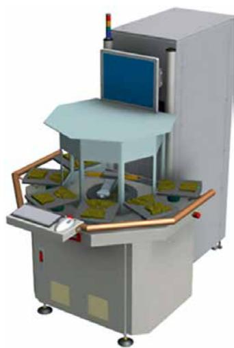
模块连接到 150 / 200 mm 硅片分类机
