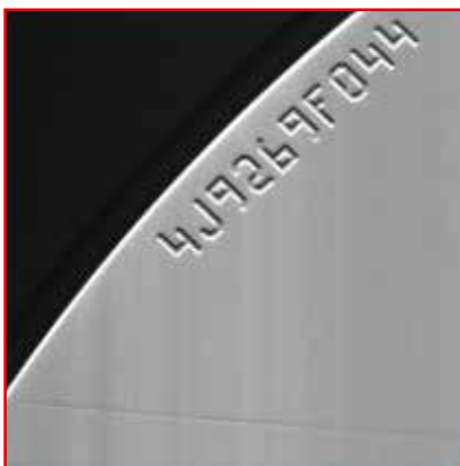
轻微划痕（使用激光 散射无法看见）
